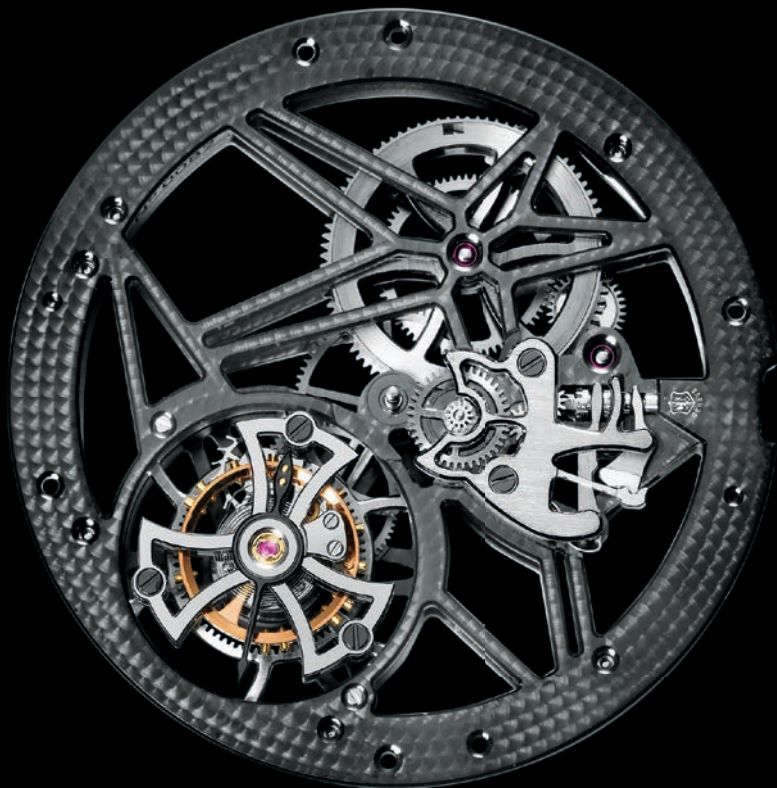
Tourbillon volante decoración cincelada RD505SQ 163 componentes, 700 horas de trabajo de fabricación, de las cuales 220 se dedican al "Poinçon de Genève".
