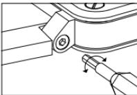
4개의 소켓 헤드 나사(육각 소켓/1.3 mm 직경)로 스트랩을 케이스 고정부에 고정합니다. 이 나사는 상자에 시계와 함께 들어 있는 2개의 공구를 사용해 조심스럽게 다루어야 합니다.
