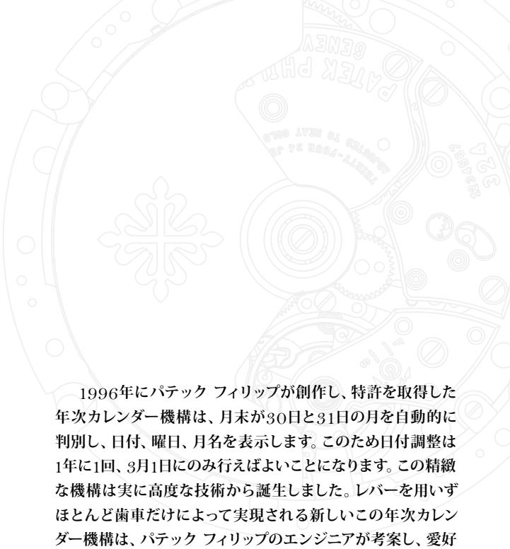
1996年にパテック フィリップが創作し、特許を取得した年次カレンダー機構は、月末が30日と31日の月を自動的に判別し、日付、曜日、月名を表示します。このため日付調整は1年に1回、3月1日にのみ行えばよいことになります。この精緻な機構は実際に高度な技術から誕生しました。レバーを用いずほとんど歯車だけによって実現される新しいこの年次カレンダー機構は、パテック フィリップのエンジニアが考案し、愛好家の絶賛を浴びています。ムーンフェイズ表示を搭載した通常の永久カレンダー・ムーブメントは約280個の部品から構成されていますが、キャリバー324SQALUには328個の部品が使われています。カレンダー表示に加え、誤差が122年間で1日という驚異的な精度を誇るムーンフェイズ表示が追加されています。
