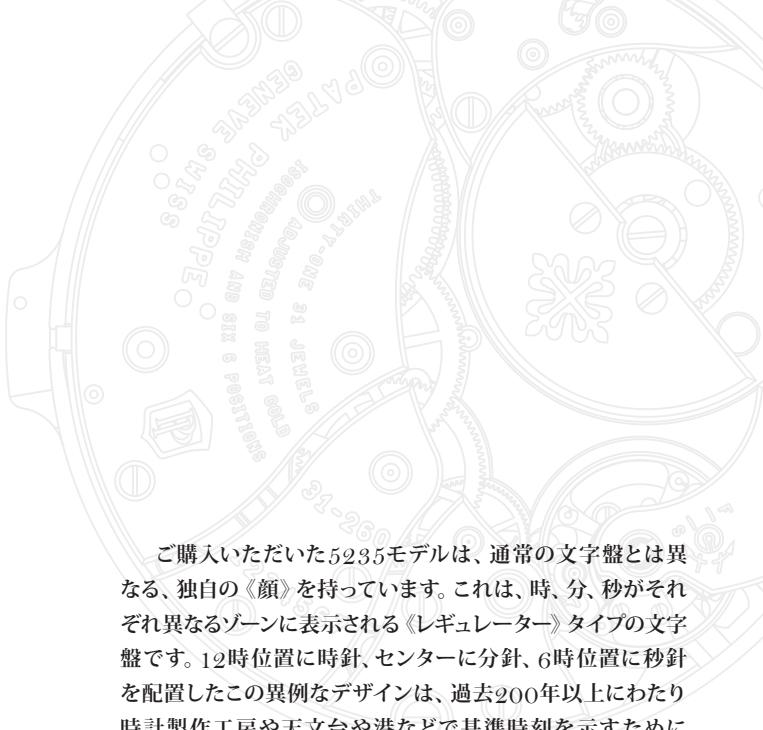
ご購入いただいた5235モデルは、通常の文字盤とは異なる、独自の《顔》を持っています。これは、時、分、秒がそれぞれ異なるゾーンに表示される《レギュレーター》タイプの文字盤です。12時位置に時針、センターに分針、6時位置に秒針を配置したこの異例なデザインは、過去200年以上にわたり時計製作工房や天文台や港などで基準時刻を示すために用いられてきた、据置式振り子時計《レギュレーター》へのオマージュです。時針が一日に2回、数時間秒針を遮ることを避けるため、時表示が文字盤の中心を外れた位置に配置されているのです。5235モデルの心臓部には、革命的なSpiromax®髭ぜんまいとPulsomax®脱進機（ガンギ車とアンクル）が搭載されています。これらは、特許取得のシリコン・ベース素材Silinvar®から作られています。5235モデルは、パテック フィリップが創作し、特許を取得した年次カレンダー機構を搭載しています。月末が30日と31日の月を自動的に判別するこの機構により、日付の調整は1年に1回のみ行なえばよいことになります。
