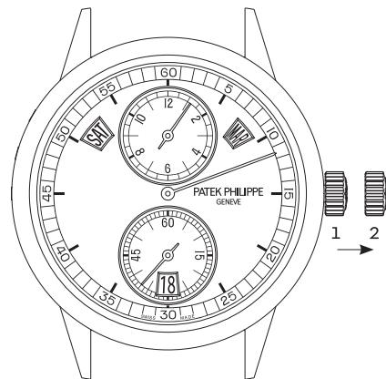
このモデルは《ストップセコンド》機構を備えており、時刻を秒針まで正確に合わせることができます。リュウズをポジション2に引き出すと、秒針がストップします。時報に合わせ、リュウズを押してポジション1に戻すと、秒針が再びスタートします。
