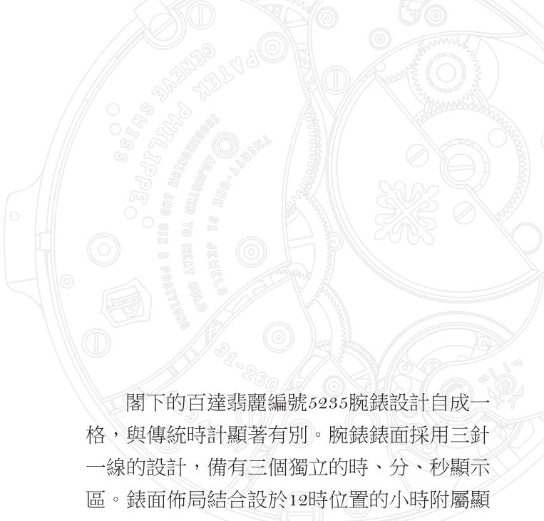
閣下的百達翡麗編號5235腕錶設計自成一格，與傳統時計顯著有別。腕錶錶面採用三針一線的設計，備有三個獨立的時、分、秒顯示區。錶面佈局結合設於12時位置的小時附屬顯示盤、中央分針和設於6時位置的小三針附屬顯示盤；設計靈感取自於以往鐘錶師、科研機構和主要港口為了精準地記錄時間而使用十分精密的座地擺鐘。為免時針在日內兩度遮蓋小三針顯示盤部分範圍數個小時，擺鐘的小時顯示都位於錶面周邊的位置。閣下的三針一線年曆腕錶，箇中的擺動器堪稱前衛，配備Spiromax®游絲和Pulsomax®擒縱器（發條、槓桿和擒縱齒輪全以Silinvar®矽製物料製成），全屬革新的專利零件。此外，閣下的腕錶亦配備年曆裝置，每年僅需調校一次。
