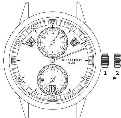
Ihre Uhr besitzt einen Sekundenstopp, der den Sekundenzeiger arretiert, sobald Sie die Krone in Position 2 ziehen. Sie erhalten dadurch die Möglichkeit, die Uhr sekundengenau auf das Signal eines akustischen Zeitzeichens einzustellen. Sobald Sie die Krone wieder an das Gehäuse drücken (Position 1), läuft der Sekundenzeiger weiter.
