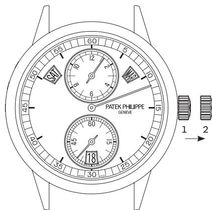
Votre montre comporte un système de «stop seconde» vous permettant de faire une mise à l'heure à la seconde près, en vous basant sur un signal acoustique. Lorsque vous tirez la couronne (position 2), l'aiguille des secondes s'arrête instantanément. Elle redémarre immédiatement lorsque vous repoussez la couronne contre le boîtier (position 1).
