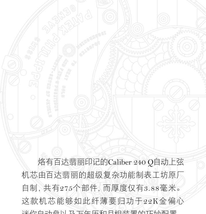
烙有百达翡丽印记的Caliber 240 Q自动上弦机芯由百达翡丽的超级复杂功能制表工坊原厂自制，共有275个部件，而厚度仅有3.88毫米。这款机芯能够如此纤薄要归功于22K金偏心迷你自动盘以及万年历和月相装置的巧妙配置。万年历配备记忆跨度长达48个月（四年）的凸轮，可自动且准确地显示日期，自动识别31天、30天和28天的月份，甚至是闰年的2月29日。2100年之前均无需手动调整，因为2100年正好是公历中没有2月29日的百数年。嵌入表壳侧面的四个校正按销可以方便地调校所有日历显示。
