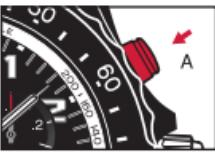
2. Для остановки хронографа еще раз нажмите кнопку **A**. Продолжительность измеренного отрезка времени отображается: в часах (счетчик **1**), минутах (стрелка **2**), секундах (стрелка **3**) и  $\frac{1}{10}$  долях секунды (счетчик **4**).
