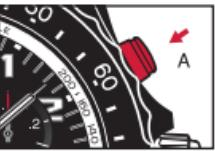
2. Arrêter la mesure en appuyant à nouveau sur le poussoir **A**. La mesure s'effectue en heures [compteur **1**], minutes [aiguille **2**], seconde [aiguille **3**] et  $\frac{1}{10}$ e de seconde [compteur **4**].
