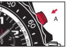
2. Parar a medição premindo novamente o pistão **A**. A medição efetua-se em horas [contador **1**], minutos [ponteiro **2**], segundos [ponteiro **3**] e  $\frac{1}{10}$  de segundo [contador **4**].
