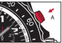
2. Fermare la misurazione premendo di nuovo il pulsante **A**. La misura si effettua in ore [totalizzatore **1**], in minuti [lancetta **2**], in secondi [lancetta **3**] e in decimi di secondo [totalizzatore **4**].
