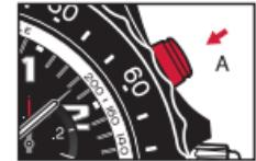
2. Чтобы остановить измерение, снова нажмите кнопку **A**. Чтобы возобновить измерение, повторно нажмите кнопку **A**. Таким образом можно измерить несколько отрезков времени и суммировать их.
