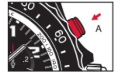
2. Unterbrechung der Zeitmessung durch Betätigen des Drückers **A**. Wiederaufnahme der Zeitmessung durch Betätigen des Drückers **A**. So lassen sich mehrere Zeitspannen messen und kumulieren.
