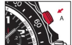
2. Pour interrompre la mesure, appuyer à nouveau sur le poussoir **A**. Pour reprendre la mesure du temps, appuyer sur le poussoir **A**. Il est ainsi possible de cumuler plusieurs temps courts.
